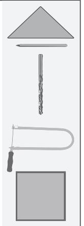
Übertrage die gewünschten Formen auf die Sperrholzplatten (A, B, C, D, E, F). Bohre anschließend in die Teile (A) auf der Innenseite jeweils ein **Loch Ø 3 mm, 5 mm tief**. Bohre in Teil (B) ein **Loch Ø 6 mm**. Säge die Teile (A) bis (E) mit der Laubsäge bzw. Feinsäge aus und arbeite alle Kanten mit Schleifpapier nach.
