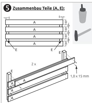
Leime die Leisten (A) nach Abbildung auf die Teile (E). Fixiere die Holzleisten zusätzlich mit jeweils 4 Nägeln. Führe diesen Arbeitsschritt zweimal durch (zwei gleiche Seiten).
