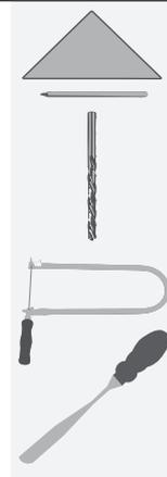
Übertrage die gewählte Form für die Schale (Plan 2) auf das **Holzbrett (A) (160 / 110 / 18 mm)**. Bohre die **2 Löcher Ø 4 mm**. Schneide jetzt die äußere Form mit der Laubsäge aus und höhle anschließend die Schalenvertiefung **mit dem Stemmeisen oder runden Schnitzmesser** aus.
