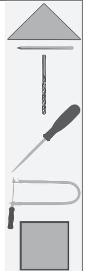
Übertrage die Schablone für Teil (A) auf das **Sperrholz (85 / 70 / 6 mm)**. Bohre jetzt das Loch  $\varnothing 3$  mm und stich die Stechpunkte mit einem **Vorstecher** vor. Säge anschließend die Form mit der **Laubsäge** aus und arbeite die **Sagekanten mit Schleifpapier** nach.  OK ✓
