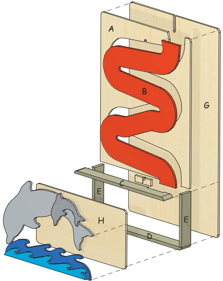
Versuche beim Sägen entlang der Schnittkanten den Laubsägebogen möglichst senkrecht zu halten.
