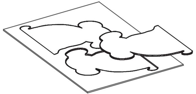
**Löse die Stanzteile** vorsichtig aus dem vorgestanzten Karton und Kork. Schleife anschließend die Kanten mit feinem **Schleifpapier** nach. Auch die Enden der Kartonrohre sollten nachgeschliffen werden.
