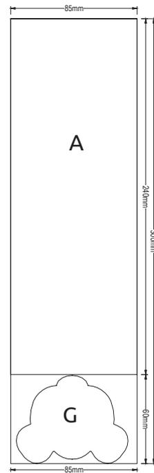
Säge von der Sperrholzplatte die Grundplatte (300 / 85 / 4 mm) und den Teil für den Tierkopf (G) laut Schablone mit der Laubsäge ab.
