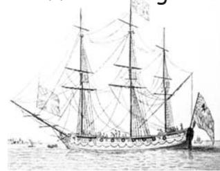
Jedes Segelschiff besteht, unabhängig von der Größe, aus drei **Bestandteilen**: einem oder mehreren Rümpfen, den Segeln und dem Rigg.
