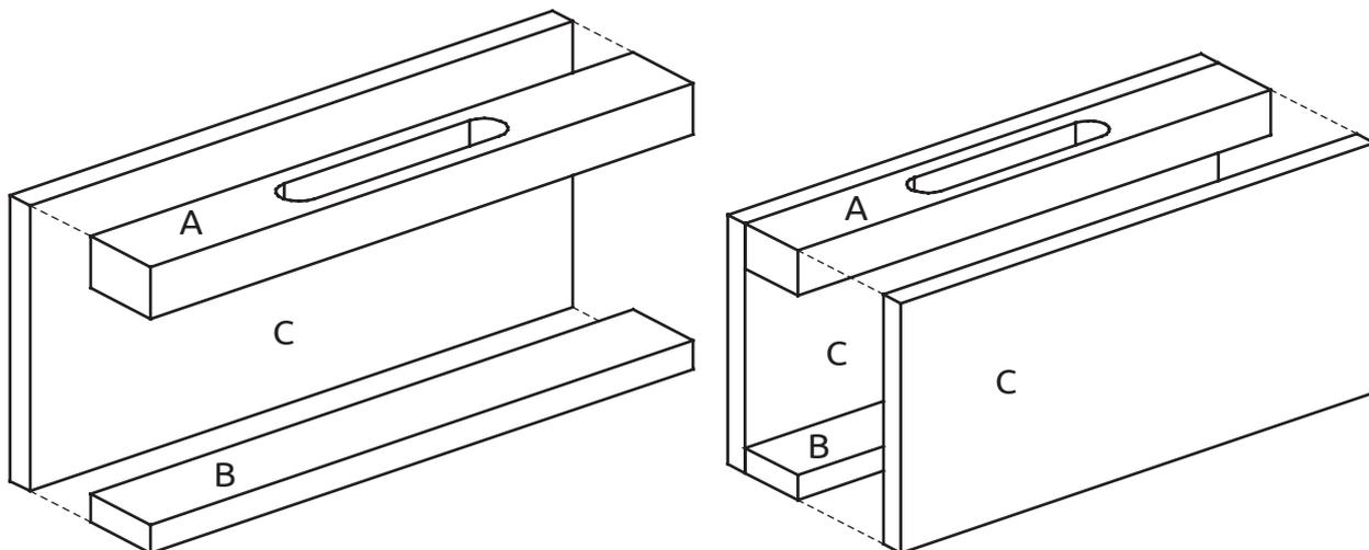
Leime die Teile (A, B, C) nach Abbildung zusammen. Arbeite alle **Kanten und Flächen mit Schleifpapier** nach. Lege dein Smartphone in die Lautsprecherbox und teste die Funktion.
